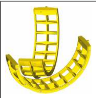
Doppelreihiger, dreiteiliger Käfig mit Rollensitz, Kamm und Deckel verschraubt, außenbordgeführt, Käfig geteilt für geteiltes Wälzlager
