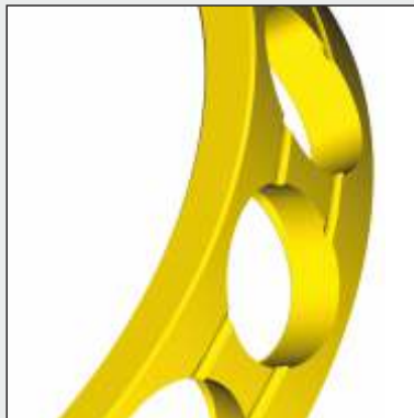
Fensterkäfig mit konischem Kugelsitz innen, Haltenasen außen angerollt Window-type cage with inner conical ball seat, outer retaining collars roll-stamped
