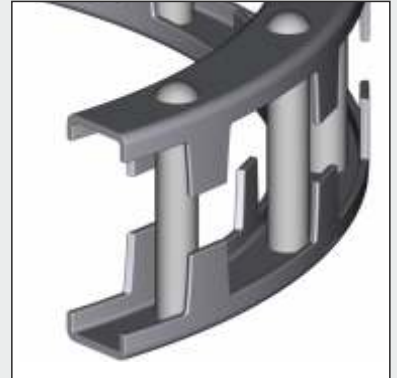
Zwei Käfighälften aus Stahlblech, Käfighälften mit Stahl Niet und Hülsen vernietet, wälzkörpergeführt Two-piece cage, cage halves with tube and riveted, cage centred on rolling element
