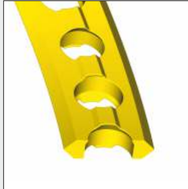
Fensterkäfig mit konischem Kugelsitz wechselseitig, Schnappkanten wechselseitig, wälzkörpergeführt Window-type cage with conical ball seat on two ways and retaining collars on two ways, cage centred on rolling element
