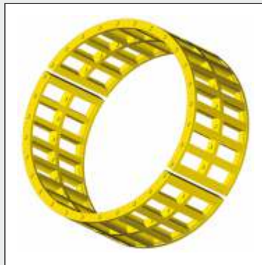
Dreiteiliger Käfig mit zylindrischem Rollensitz, doppelreihig, Kamm und zwei Deckel, stegvernietet, Zapfen angewirbelt, Käfig geteilt für geteiltes Wälzlager Three-piece cage with cylindrical roller seat, two cage caps and one cage body, body and caps crosspiece riveted, cage split for split bearing
