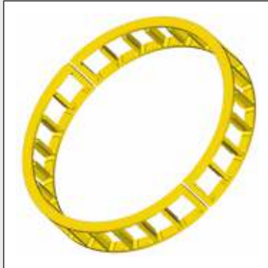
Fensterkäfig mit Rollensitz innen, Schnappkanten außen, Fenster gefräst mit Eckbohrungen, Käfig geteilt für geteiltes Wälzlager Window-type cage with inner cylindrical roller seat and outer retaining collars, window milled with bored free corners, cage split for split bearing
