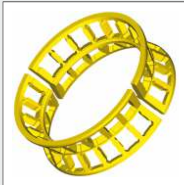
Doppelreihiger Käfig mit Rollensitz innen, Haltenasen außen, Fenster gefräst mit Eckbohrungen, Käfig geteilt für geteiltes Wälzlager Double-row window-type cage with inner roller seat, windows milled with bored free corners and outer retaining collars, split cage for split bearing
