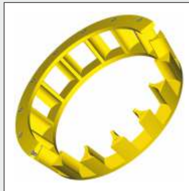
Zweiteiliger Käfig mit Rollensitz, Kamm und Deckel über Falz zentriert und verschraubt, wälzkörpergeführt Two-piece cage with roller seat, cage cap and cage body, cap and body fold centred and screwed together, cage centred on rolling element
