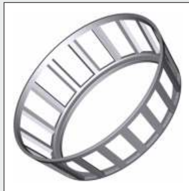
Fensterkäfig aus Stahlblech, Fenster wasserstrahlgeschnitten mit durchgängigem Rollensitz Sheet metal window-type cage, waterjet-cutted windows with cutted roller seat, cage centred on rolling element
