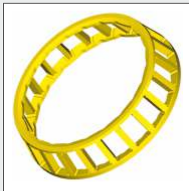
Fensterkäfig ohne Rollensitz, Haltenasen außen, Fenster gefräst mit Eckbohrungen, mit Schmiernuten Window-type cage without roller seat, outer retaining collars, windows milled with bored free corners
