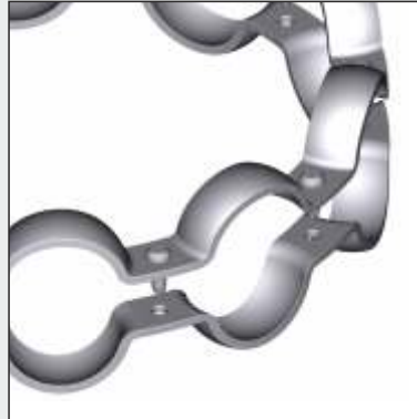
Stahlblechkäfig mit sphärischem Kugelsitz und Nieten, Nieten vorgesteckt, wälzkörpergeführt Rivet cage with spherical ball seat, steel sheet metal, rivet preassembled, cage ball centred
