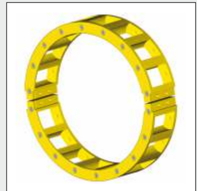
Zweiteiliger Käfig mit Rollensitz, Kamm und Deckel verschraubt, Käfig geteilt für geteiltes Wälzlager, mit Distanzplatte verschraubt Two piece cage with cylindrical roller seat, cage cap and cage body, body and cap pinned and screwed together, cage split for split bearing, split halves screwed with distance disk
