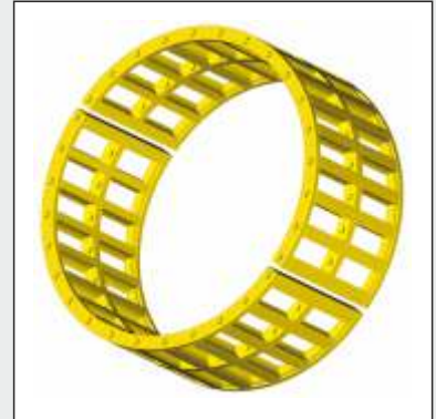
Dreiteiliger Käfig mit zylindrischem Rollensitz, doppelreihig, Kamm und zwei Deckel, stegvermietet, Zapfen angewirbelt, Käfig geteilt für geteiltes Wälzlager Three-piece cage with cylindrical roller seat, two cage caps and one cage body, body and caps crosspiece riveted, cage split for split bearing
