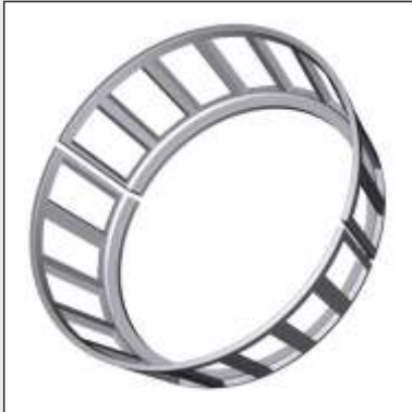
Fensterkäfig aus Stahlblech, Fenster wasserstrahlgeschnitten mit durchgängigem Rollensitz, Käfig geteilt für Schweißmontage Sheet metal window-type cage, waterjet-cutted windows with cutted roller seat, cage centred on rolling element, cage split for split bearing, split halves welded together after assembly
