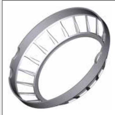
Fensterkäfig aus Stahlblech mit Rollensitz, Fenster gestanzt und Montagesicken Sheet metal window-type cage, windows punched with stamped roller seat
