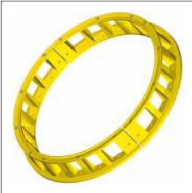
Zweiteiliger Käfig mit Rollensitz, Kamm und Deckel verschraubt, außenbordgeführt, Käfig geteilt für geteiltes Wälzlager
