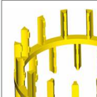
Doppelreihiger Käfig mit Rollensitz außen, Schnappkante innen Double-row cage with outer cylindrical roller seat and inner retaining collars
