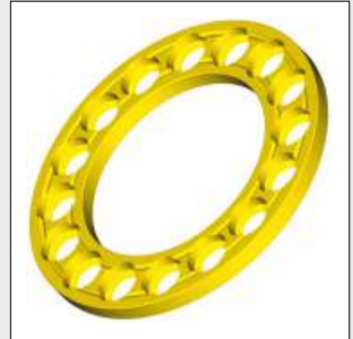
Fensterkäfig mit konischem Kugelsitz einseitig, Tasche verstemmt Window-type cage with conical ball seat on single side, with retaining collars peened over
