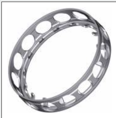
Fensterkäfig aus Stahlblech mit konischem Kugelsitz, mit Montagelappen Sheet metal window-type cage with conical ball seat and retaining collars
