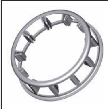
Fensterkäfig Stahlblech, Fenster gestanzt, Lappen nach innen gebogen Sheet metal window-type cage, windows punched with inner retaining collars
