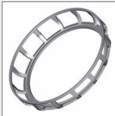
Fensterkäfig aus Stahlblech, Fenster gestanzt, Schnappkante geprägt Sheet metal window-type cage, windows punched with stamped retaining collar
