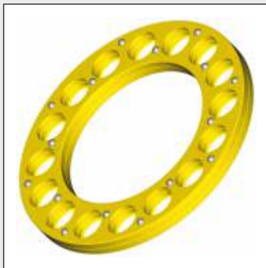
Zwei Käfighälften mit konischem Kugelsitz, Käfighälften mit Stahlniet vernietet, wälzkörpergeführt Two-piece cage with conical ball seat, cage halves riveted
