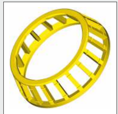
Fensterkäfig ohne Rollensitz, Fenster geräumt, mit Schmiernuten, Haltenasen außen angerollt Window-type cage without roller seat, windows broached, outer retaining collars roll-stamped
