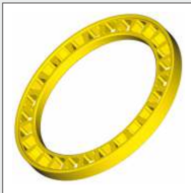
Fensterkäfig ohne Rollensitz, Fenster gefräst mit Eckbohrungen, bordgeführt Window-type cage without roller seat, windows milled with bored free corners, centred on washer
