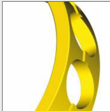
Fensterkäfig ohne Kugelsitz, Haltenasen außen Window-type cage without ball seat, with outer retaining collars
