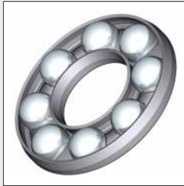
Fensterkäfig aus Stahlblech mit Sicke, Kugeln vormontiert, wälzkörpergeführt Sheet metal window-type cage with ditch, balls preassembled, cage centred on rolling element
