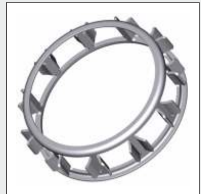
Fensterkäfig Stahlblech, Fenster gestanzt, Lappen nach außen gebogen Sheet metal window-type cage, windows punched with outer retaining collars
