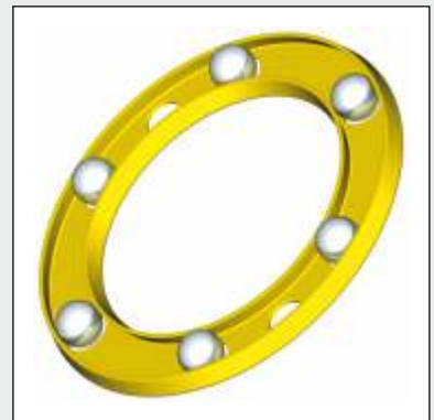
Fensterkäfig aus Messingblech, geprägter Kugelsitz, Kugeln vormontiert, wälzkörpergeführt Brass sheet metal window-type cage with stamped ball seat, Balls preassembled, cage centred on rolling element
