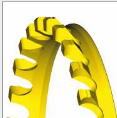
Käfig mit konischem Kugelsitz, Schnappkanten angerollt, wälzkörpergeführt Cage with conical ball seat, retaining collars roll-stamped, cage centred on rolling element
