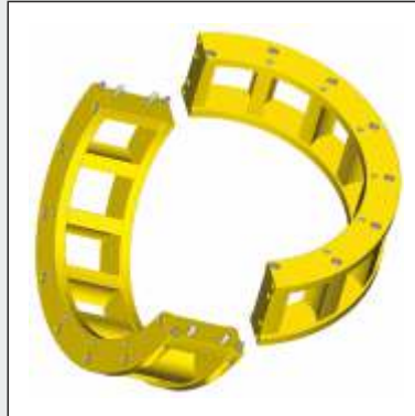
Zweiteiliger Käfig mit Rollensitz, Kamm und Deckel verschraubt, Käfig geteilt für geteiltes Wälzlager, verschraubt und verstiftet Two piece cage with cylindrical roller seat, cage cap and cage body, body and cap pinned and screwed together, cage split for split bearing, split halves pinned and screwed together
