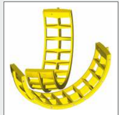
Doppelreihiger, dreiteiliger Käfig mit Rollensitz, Kamm und Deckel verschraubt, außenbordgeführt, Käfig geteilt für geteiltes Wälzlager Double-row three-piece cage with roller seat, two cage caps and one cage body, body and caps screwed together, cage split for split bearing, cage centred on outer ring
