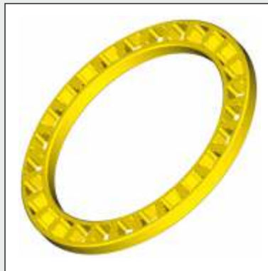
Fensterkäfig ohne Rollensitz, Fenster gefräst mit Eckbohrungen, Schnappnasen gefräst Window-type cage without roller seat, windows milled with bored free corners and retaining collars
