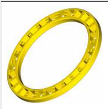
Fensterkäfig ohne Rollensitz, Fenster geräumt, beidseitig verstemmt Window-type cage without roller seat, windows broached, retaining collars peened over on both sides
