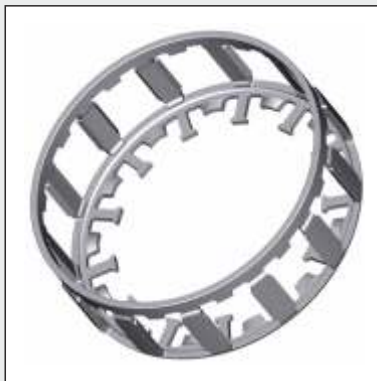
Fensterkäfig Stahlblech, Fenster gestanzt mit Rollensitz und Haltelappen Sheet metal window-type cage, windows punched with stamped roller seat, with retaining lips
