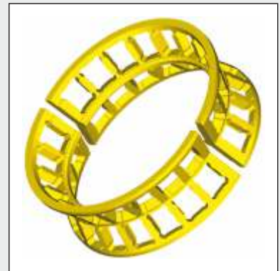
Doppelreihiger Käfig mit Rollensitz innen, Haltenasen außen, Fenster gefräst mit Eckbohrungen, Käfig geteilt für geteiltes Wälzlager Double-row window-type cage with inner roller seat, windows milled with bored free corners and outer retaining collars, split cage for split bearing
